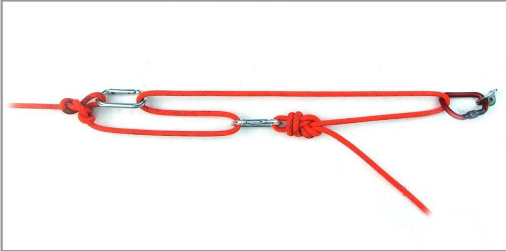
[그림 4-109] 기본 티롤리언 브릿지의 당김 시스템
