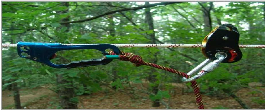
[그림 4-130] 진입장치 설치
