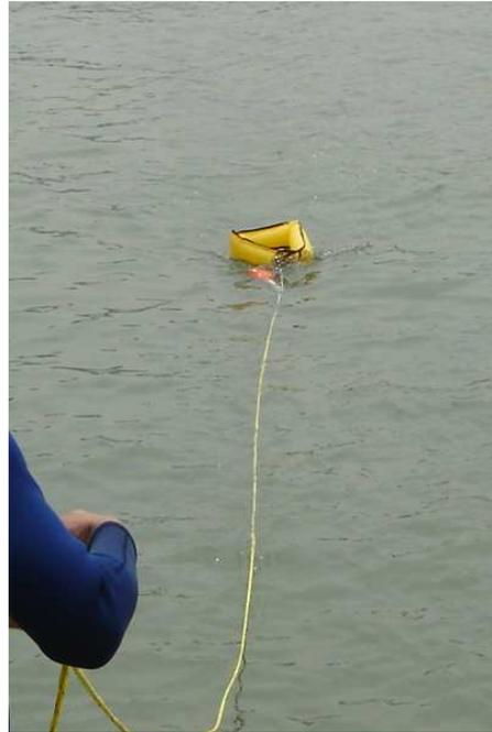
[그림 4-209] 구조로켓의 발사 모습. 로켓이 물에 닿으면 자동으로 구명환이 펼쳐진다.
