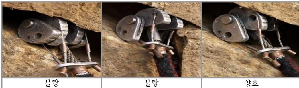
[그림 3-65] 캠 설치 방법
