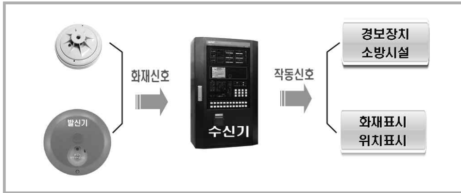
[그림 2-1] 자동화재탐지설비의 작동흐름도
