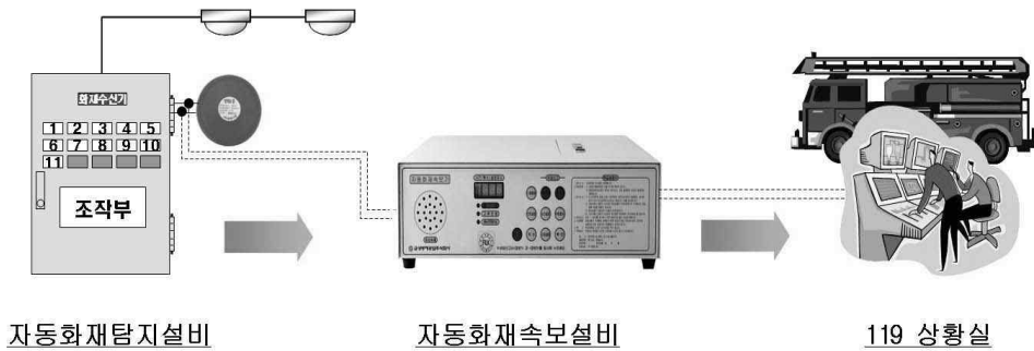
[그림 2-73] 자동화재속보설비 작동 구성도
