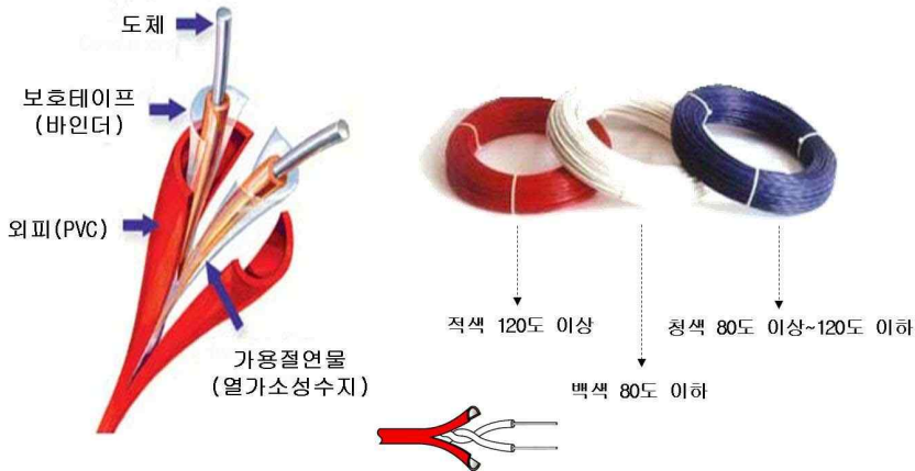
[그림 2-16] 정온식감지선형감지기의 형태 및 표시
