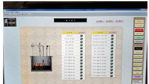
● 수위감지기에 의해 자동운전 및 방재실에서 상태 감시
