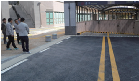
● 램프 진출 차량과 보행자 동선 간섭에 따른 안전사고 우려
