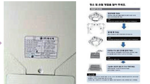
● 전열교환기 필터 교체주기 및 방법 장비부착 및 안내책자 작성 배포
