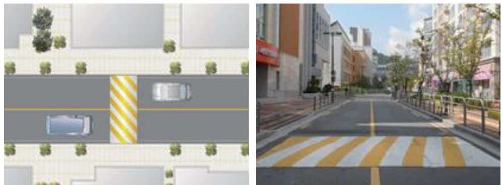
<과속방지턱 설치 예시>
