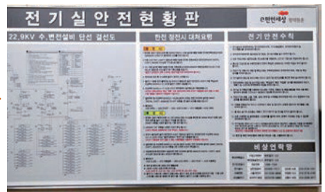
● 전기실 준공표지판 부착(단선결선도, 안전 수칙 및 비상연락망 포함)
