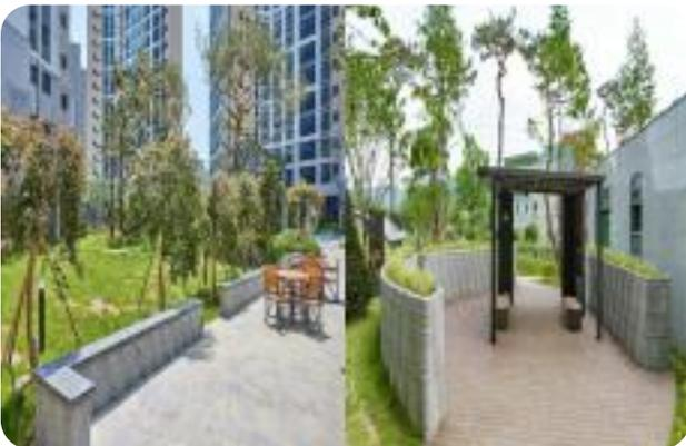
3D 콘크리트 프린팅을 활용하여 벤치와 화단 조형물 설치
