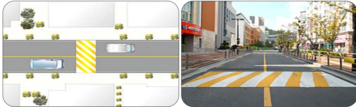
< 과속방지턱 설치 예시 >
