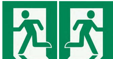
▲ 탈출구(왼쪽) ▲ 탈출구(오른쪽) ▲ 피난구유도등의 표시방향과 비상구의 위치가 일치하도록 설치
