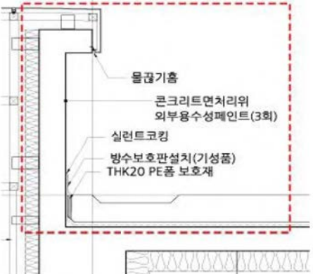
▲ 파라펫벽체에 완충재 설치로 무근콘크리트 응력을 해소(PE완충재) ▲ 파라펫과 콘크리트벽 사이에 밀실 마감처리(해충류 등 유입차단)
