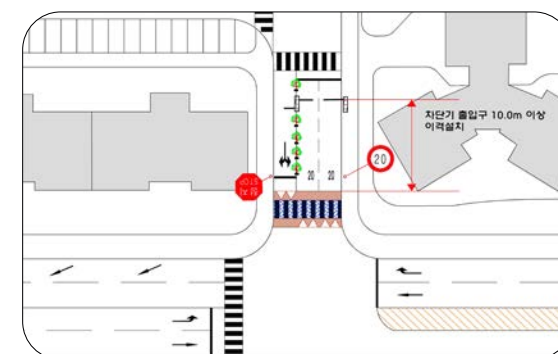
< 진출입로 안전시설 및 차단기 설치 >
