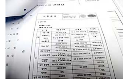
▲ 세대 방화문은 현장에서 샘플 채취하여 적정성 확인(시험성적서 확인)
