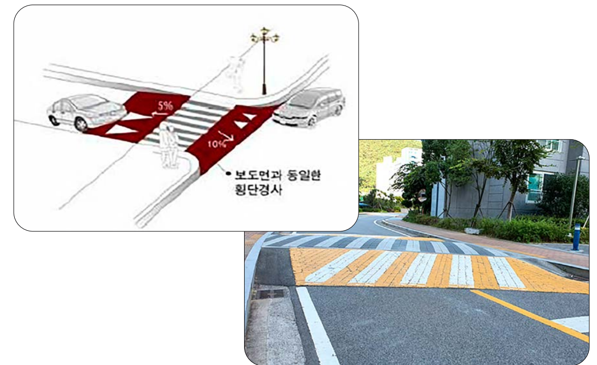
< 고원식 횡단보도 설치 예시 >
