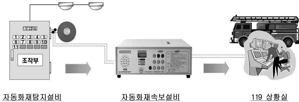
[그림 2-73] 자동화재속보설비 작동 구성도
