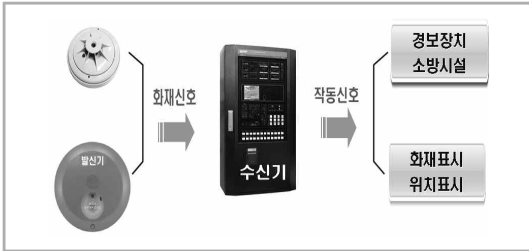
[그림 2-1] 자동화재탐지설비의 작동흐름도
