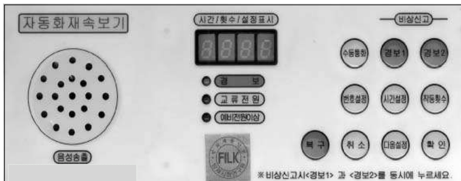
[그림 2-74] 자동화재속보기의 표시등 및 스위치
