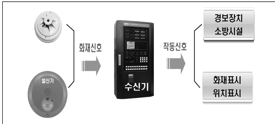
[그림 2-1] 자동화재탐지설비의 작동흐름도
