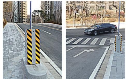
● 인도 및 차도 주차차단기 안전시설 (안전 울타리, SUS안전봉, 탄력봉) 설치
