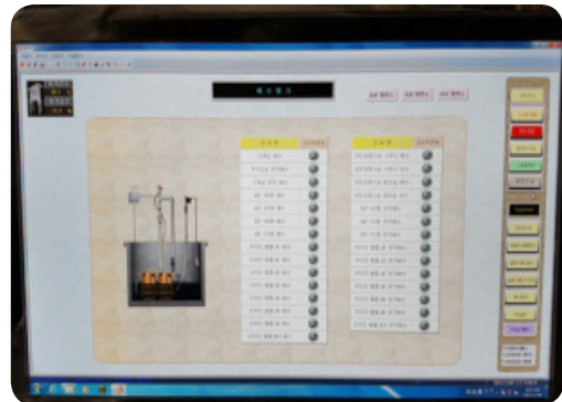
- 수위감지기에 의해 자동 운전 및 방재실에서 상태 감시
