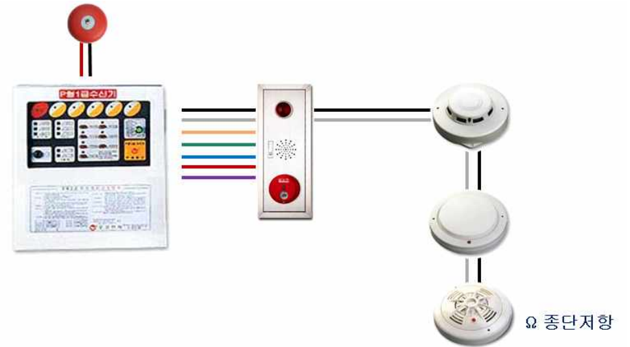
【그림1】 자동화재탐지설비의 구성
